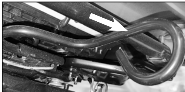
Levier pour débloquer le siège
