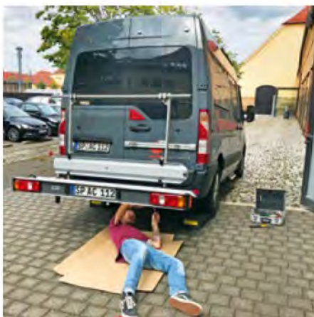
Die Sicherungen unter dem Fahrzeug sind nicht so einfach zu erreichen. Montage und Demontage sind mit gewissem Aufwand verbunden.
